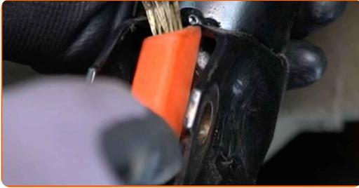
**46** Die Keilwellen des CV-Gelenks der Antriebswelle reinigen. Benutzen Sie eine Drahtbürste. Benutzen Sie WD-40-Spray.
