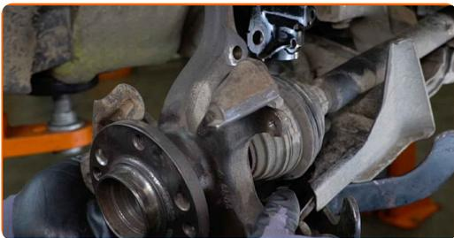
**50** Befestigen Sie das Dämpferbein auf dem Achsschenkel.
