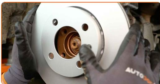
**70** Ziehen Sie die Befestigung der Bremsscheibe fest. Verwenden Sie den Torx T30. Verwenden Sie einen Drehmomentschlüssel. Ziehen Sie ihn mit 4 Nm Drehmoment fest.
