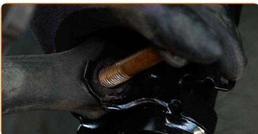
**52** Verbinden Sie das Kugelgelenk mit dem Lenker.
