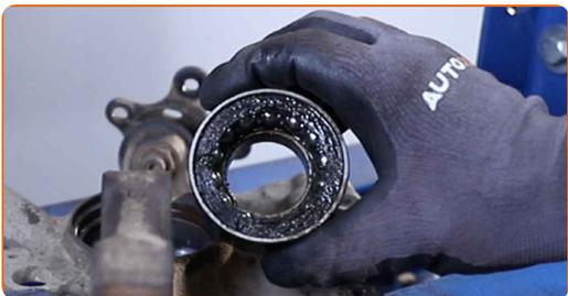
**37** Reinigen Sie den Einbauort für die Nabenlagerung. Benutzen Sie eine Drahtbürste. Benutzen Sie WD-40-Spray.
