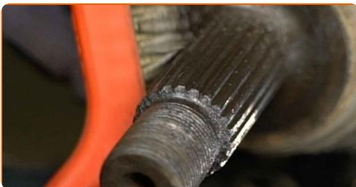
**47** Behandeln Sie die Keilwellen des Antriebswellen-Gleichlaufgelenks. Benutzen Sie ein Kupferschmiermittel.
