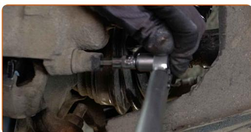
**74** Behandeln Sie die Befestigungen des Kugelgelenks. Behandeln Sie die Federbein-Befestigungen. Behandeln Sie das Befestigungselement, das den Spurstangenkopf mit dem Achsschenkel verbindet. Benutzen Sie ein Kupferschmiermittel.
