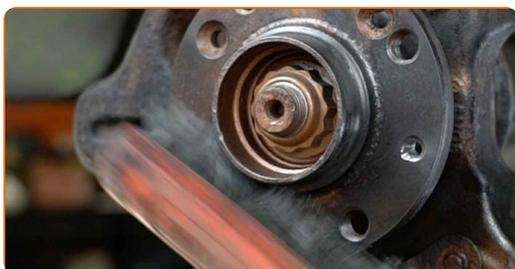
**67** Säubern Sie die Halterung des Bremssattels. Benutzen Sie eine Drahtbürste. Benutzen Sie einen Bremsenreiniger.
