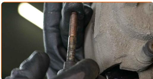
**73** Ziehen Sie die Bremssattelbefestigungen fest. Verwenden Sie Inbusschlüssel Nr. H6. Verwenden Sie einen Drehmomentschlüssel. Ziehen Sie ihn mit 25 Nm Drehmoment fest.
