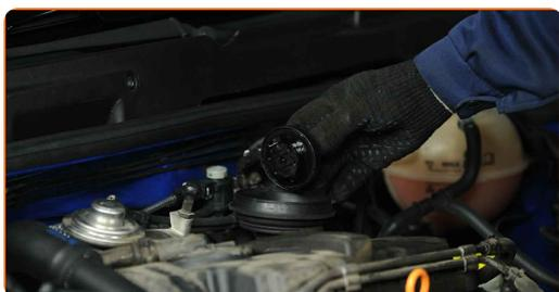
**28** Befestigen Sie den Deckel des Öleinfüllstutzens.
