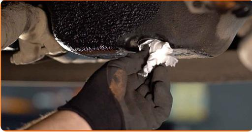
**6** Schrauben Sie die neue Ablassschraube ein und ziehen Sie sie fest. Verwenden Sie Stecknuss Nr. 19. Verwenden Sie einen Drehmomentschlüssel. Ziehen Sie ihn mit 28 Nm Drehmoment fest.
