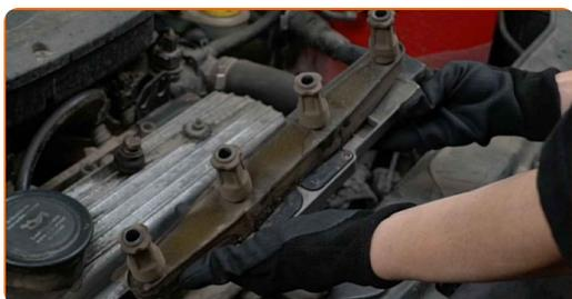
**7** Entfernen Sie Schmutz, Staub und Ablagerungen von den Zündkerzenbohrung.
