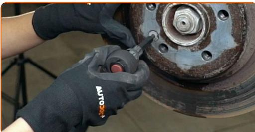
**16** Entfernen Sie die Bremsscheibe. Verwenden Sie einen Gummi-Hammer.
