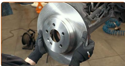
**20** Ziehen Sie die Befestigung der Bremsscheibe fest. Verwenden Sie Inbusschlüssel Nr. H5. Verwenden Sie einen Drehmomentschlüssel. Ziehen Sie ihn mit 8 Nm Drehmoment fest.
