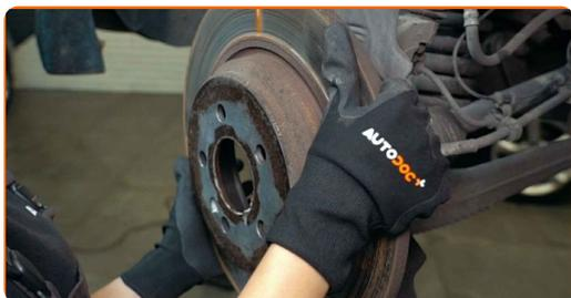
**17** Bewegen Sie die Feststellbremsbacken gegen die Trommel. Verwenden Sie einen flachen Schraubendreher.
