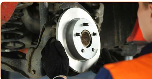
**18** Reinigen Sie die Befestigungen des Radnabenlagers. Benutzen Sie eine Drahtbürste. Benutzen Sie WD-40-Spray.
