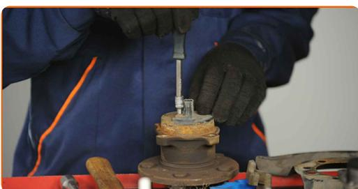
**25** Lösen Sie den ABS-Sensor.
