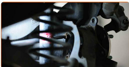
**34.2** Verwenden Sie den Torx T50. Verwenden Sie einen Drehmomentschlüssel. Ziehen Sie ihn mit 62 Nm Drehmoment fest.
