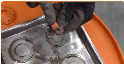
**29** Reinigen Sie den Einbauort für die Nabenlagerung. Benutzen Sie eine Drahtbürste. Benutzen Sie WD-40-Spray.
