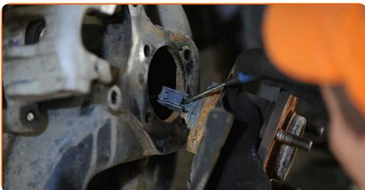
**23** Entfernen Sie das Bremsenabdeckblech.
