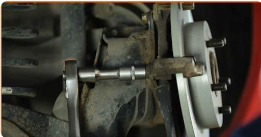
**15** Entfernen Sie die Befestigungsschrauben (2 Stück).
