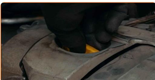
**23** Befestigen Sie den Deckel des Öleinfüllstutzens.
