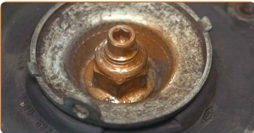
**41** Dekomprimieren Sie die Feder.
