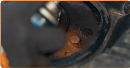
**62** Setzen Sie die Federbeinlagerkappe auf.
