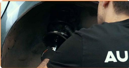
**45** Schrauben Sie die obere Befestigung des Domlagers an.
