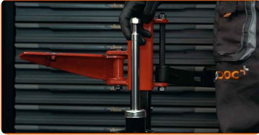
35 Installieren Sie die Staubschutzmanschette und den Anschlagpuffer auf dem neuen Stoßdämpfer.
