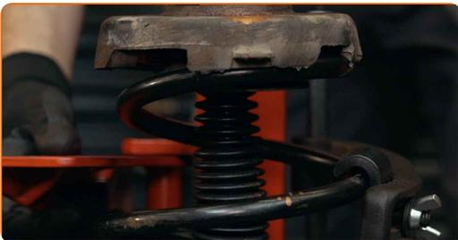
**42** Entfernen Sie das zusammengebaute Federbein.
