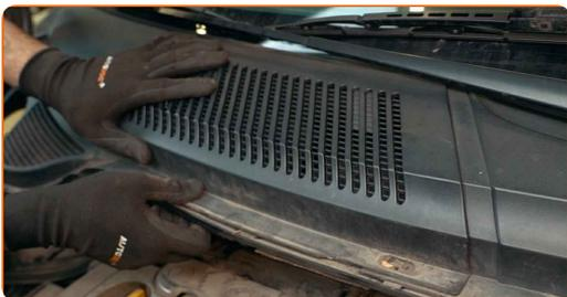
**65** Bauen Sie das Windabweiserabdeckung ein und sichern Sie diese. Verwenden Sie den Torx T20. Verwenden Sie einen Ratschenschlüssel.
