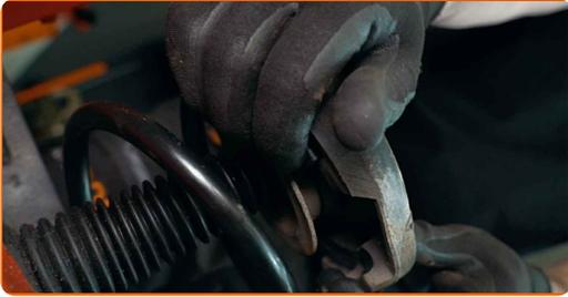
**39** Ziehen Sie die Federbeinkolbenstangenmutter an. Verwenden Sie eine 21 mm Schienenmutterstecknuss. Verwenden Sie Inbusschlüssel Nr. H6. Verwenden Sie einen Drehmomentschlüssel. Ziehen Sie ihn mit 60 Nm Drehmoment fest.
