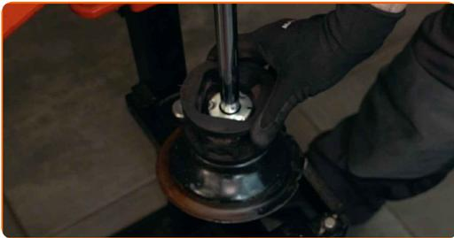
36 Installieren Sie die Feder am Stoßdämpfer.
