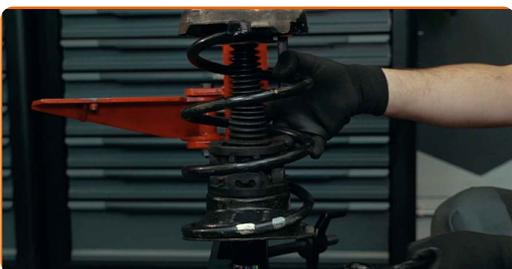
**43** Reinigen Sie die Anbringungssitze des Federbeins. Benutzen Sie eine Drahtbürste. Benutzen Sie WD-40-Spray.
