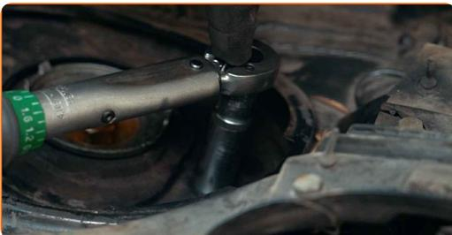
**61** Behandeln Sie die Befestigungselemente des Federbeinstützlagers. Benutzen Sie ein Kupferschmiermittel.
