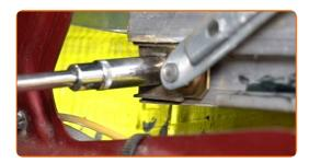
Heben Sie die Scheibe ein wenig an und lösen Sie sie vom Fensterheber.
