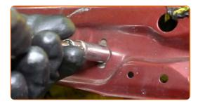
Entfernen Sie die Befestigungsschrauben.
