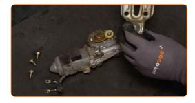
Installieren Sie die Befestigungen des Motors am neuen Fensterhebermechanismus und schrauben Sie sie an. Verwenden Sie Stecknuss Nr. 10. Verwenden Sie einen Drehmomentschlüssel. Ziehen Sie ihn mit 8 Nm Drehmoment fest.
