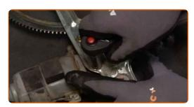
Entfernen Sie den Motor des elektrischen Fensterhebers.
