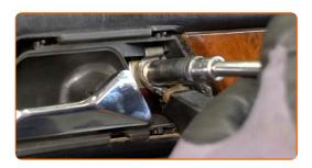
Entfernen Sie die Abdeckung, die die Befestigungsschrauben der Außenspiegel verdeckt.
