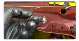
17 Entfernen Sie den Fensterhebermechanismus.
