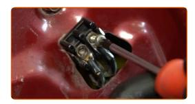
Schrauben Sie die Befestigungselemente der Fensterheberbaugruppe ab. Verwenden Sie Stecknuss Nr. 10. Verwenden Sie einen Ratschenschlüssel.
