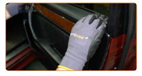
Montieren Sie die Abdeckung des Außenspiegels.
