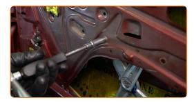
Behandeln Sie die Anschlüsse des Fensterhebermechanismus mit einem Kontaktspray. Verwenden Sie dielektrisches Fett.
