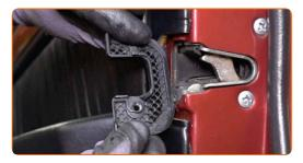
Lösen Sie die Türgriffverkleidung. Verwenden Sie einen Zierleistenkeil.
