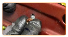
Ziehen Sie die Befestigungselemente der Fensterheberbaugruppe fest. Verwenden Sie Stecknuss Nr. 10. Verwenden Sie einen Drehmomentschlüssel. Ziehen Sie ihn mit 8 Nm Drehmoment fest.
