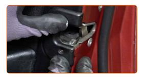
Schrauben Sie die Befestigungsschraube der Abdeckung des Türschlosses ein. Verwenden Sie einen flachen Schraubendreher.
