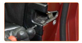
Ziehen Sie die Befestigungen der Türverkleidung fest. Verwenden Sie Stecknuss Nr. 10. Verwenden Sie einen Drehmomentschlüssel. Ziehen Sie ihn mit 8 Nm Drehmoment fest.
