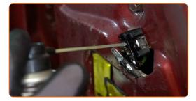
Schrauben Sie die Anschlüsse des Fensterhebermechanismus ein. Verwenden Sie einen Kreuzschlitzschraubendreher.
