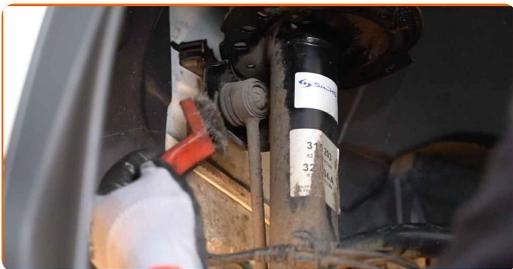
**10** Schrauben Sie das Befestigungselement heraus, das die Druckstange mit dem Federbein verbindet. Verwenden Sie Ring-Gabelschlüssel Nr. 16.
