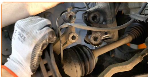
**20** Lösen Sie die obere Befestigung des Domlagers.
