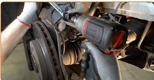
**16** Entfernen Sie die Befestigungsschraube.
