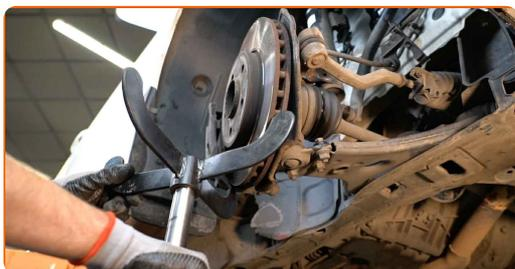
**18** Entfernen Sie die Befestigungsschraube.
