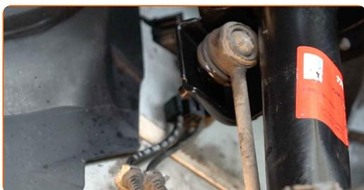
**51** Ziehen Sie das Befestigungselement an, das die Druckstange mit dem Federbein verbindet. Verwenden Sie Stecknuss Nr. 16. Verwenden Sie einen Drehmomentschlüssel. Ziehen Sie ihn mit 60 Nm Drehmoment fest.
