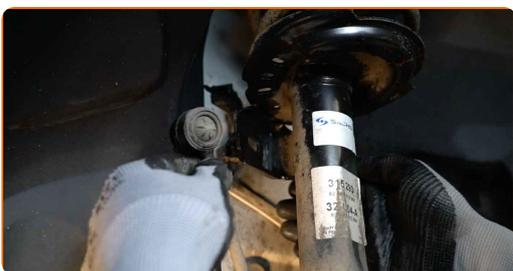
**12** Trennen Sie die ABS Sensorverdrahtung. Trennen Sie den Stecker der Verschleißsensoren des Bremsbelags.
