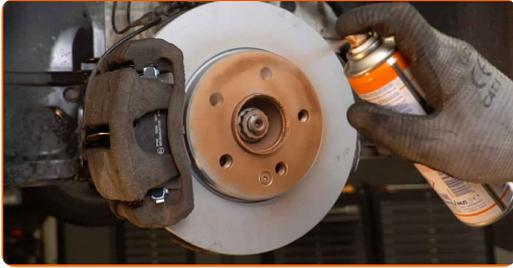
**53** Die Bremsscheibenoberfläche reinigen. Benutzen Sie einen Bremsenreiniger.
