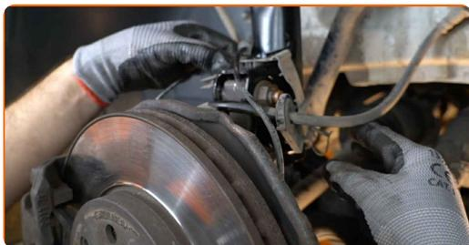
**47** Verbinden Sie das ABS mit der Sensorverdrahtung.
