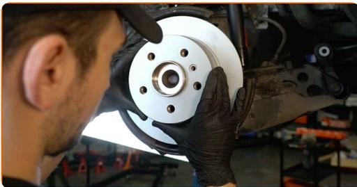
**29** Ziehen Sie die Befestigung der Bremsscheibe fest. Verwenden Sie den Torx T30. Verwenden Sie einen Drehmomentschlüssel. Ziehen Sie ihn mit 9 Nm Drehmoment fest.
