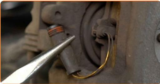
**8** Reinigen Sie die Befestigungselemente des Kabelbaums des Bremsbelagverschleißsensors. Benutzen Sie eine Drahtbürste. Benutzen Sie WD-40-Spray.
