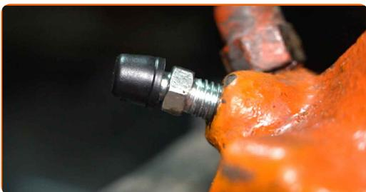
**62** Montieren Sie den Stecker des Bremsbelagverschleißsensors.
