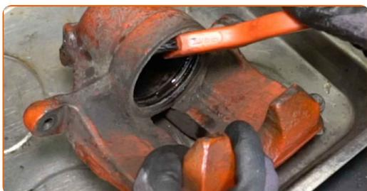
**34** Entfernen Sie die Bremssattelführungsbolzen.
