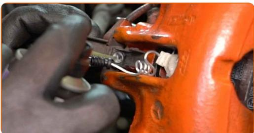
**66** Bringen Sie den Steckverbinder des Verschleißsensors der Bremsbeläge an.
