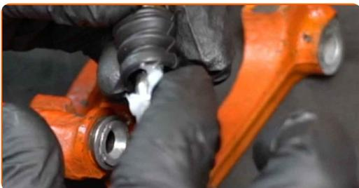
**43** Montieren Sie die Bremssattelführungsbolzen.
