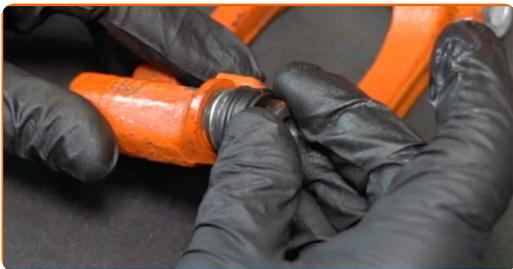
**44** Ziehen Sie die Bremsentlüftungsschraube an.
