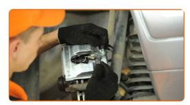
Verbinden Sie den Stecker des Verschleißseonsors der Bremsbeläge. Verwenden Sie einen flachen Schraubendreher.
