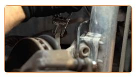
Schrauben Sie den Bremsschlauch vom Bremssattel ab. Verwenden Sie einen offenen Ringschlüssel #14.
