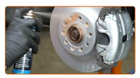
Die Bremsscheibenoberfläche reinigen. Benutzen Sie einen Bremsenreiniger.
