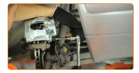
Installieren Sie die Staubschutzkappen der Bremssattel-Führungsstifte.
