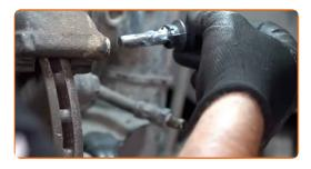
Ziehen Sie die Bremssattelbefestigungen fest. Verwenden Sie Inbusschlüssel Nr. H7. Verwenden Sie einen Drehmomentschlüssel. Ziehen Sie ihn mit 35 Nm Drehmoment fest.
