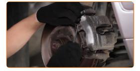
Trennen Sie den Stecker der Verschleißsensoren des Bremsbelags. Verwenden Sie einen flachen Schraubendreher.
