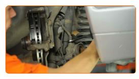
19 Trennen Sie den Bremsschlauch.
