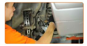
Entfernen Sie die Klammer des Bremsschlauchs.
