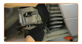
Trennen Sie den Bremsbelag Verschleißsensor. Verwenden Sie den Torx T30. Verwenden Sie einen Ratschenschlüssel.
