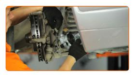
Ziehen Sie das Befestigungselement an, das die Bremsleitung mit dem Bremssattel verbindet. Verwenden Sie einen offenen Ringschlüssel #14. Verwenden Sie einen Drehmomentschlüssel. Ziehen Sie ihn mit 18 Nm Drehmoment fest.
