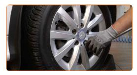
Entfernen Sie den Wagenheber sowie die Unterlegkeile.
