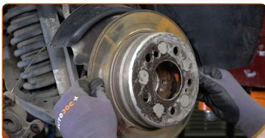
**22** Entfernen Sie die untere Rückholfeder der Bremsbacke. Verwenden Sie einen flachen Schraubendreher.
