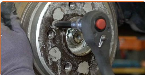
**19** Entfernen Sie die Befestigungsschraube.
