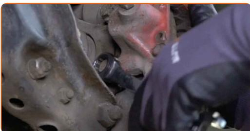
**15** Entfernen Sie die Befestigungsschrauben.
