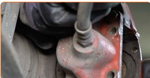
**16** Entfernen Sie den Bremssattel.
