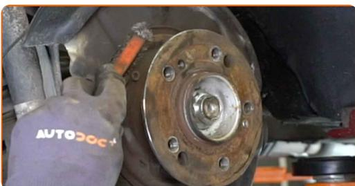
**26** Entfernen Sie den Nachsteller der Feststellbremse.
