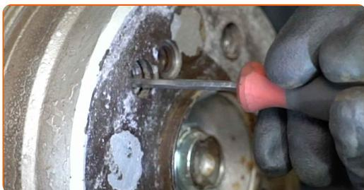
**21** Entfernen Sie die Bremsscheibe.
