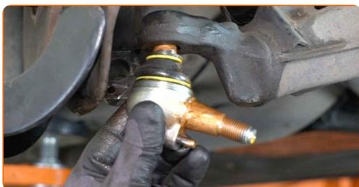
**15** Verbinden Sie das Kugelgelenk mit dem Lenker.
