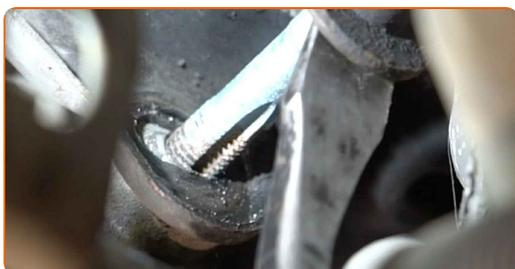
**12** Schrauben Sie die Befestigung heraus, die den Querlenker mit dem Hinterachsgelenk verbindet. Verwenden Sie Ring-Gabelschlüssel Nr. 16. Verwenden Sie Inbusschlüssel Nr. H5. Verwenden Sie einen Ratschenschlüssel.
