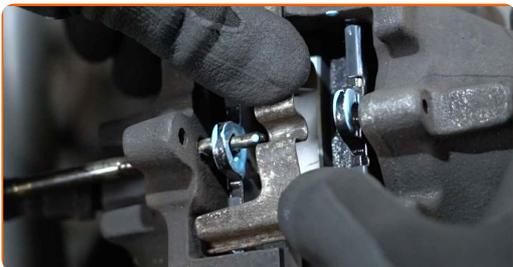
**17** Bringen Sie die Haltefeder des Bremsbelags an. Verwenden Sie einen Splintentreiber. Benutzen Sie einen Hammer.
