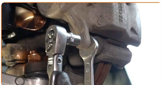
**11** Entfernen Sie die Befestigungsschrauben.
