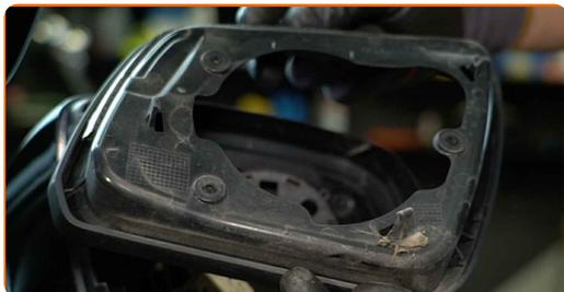
**11** Lösen Sie die Laschen des Rahmens des Spiegelgehäuses. Verwenden Sie einen Zierleistenkeil.
