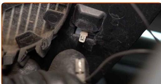
**8** Schrauben Sie die Befestigungselemente des Rahmens des Spiegelgehäuses ab. Verwenden Sie den Torx T10.
