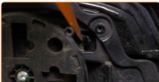
**12** Entfernen Sie das Außenspiegelgehäuse.
