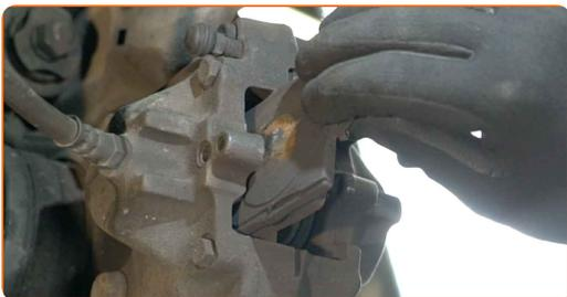
**12** Die Bremssattelbefestigungen reinigen. Benutzen Sie eine Drahtbürste. Benutzen Sie WD-40-Spray.
