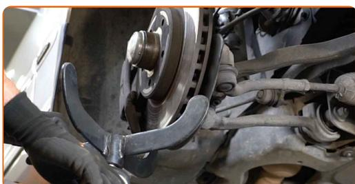
**23** Entfernen Sie die Befestigungsschraube.
