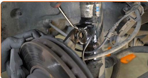
**25** Lösen Sie die obere Befestigung der Federbeinbefestigung.
