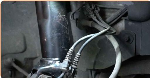
**54** Reinigen Sie die Montagesitze der Koppelstange. Benutzen Sie eine Drahtbürste. Benutzen Sie WD-40-Spray.
