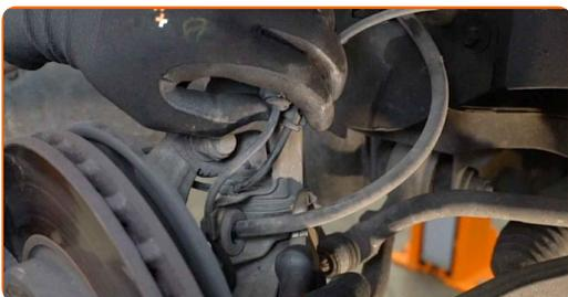
**14** Trennen Sie die Verkabelung des ABS-Sensors.
