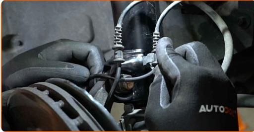
**53** Verbinden Sie das Bremsbelagverschleißkabel.
