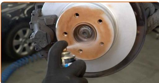
**19** Die Bremsscheibenoberfläche reinigen. Benutzen Sie einen Bremsenreiniger.
