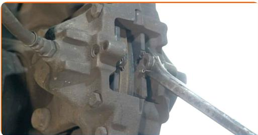
**11** Entfernen Sie die Bremsbeläge.
