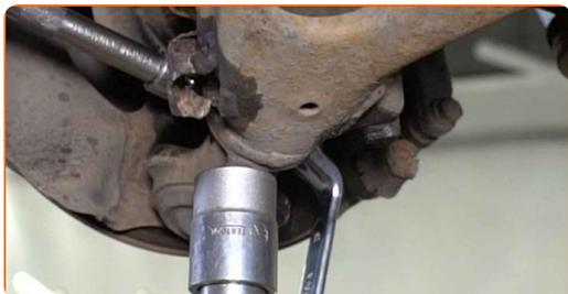
**19** Entfernen Sie die Befestigungsschraube.
