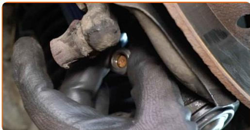
**33** Ziehen Sie das Befestigungselement fest, das das Traggelenk mit dem Achsschenkel verbindet. Verwenden Sie Ring-Gabelschlüssel Nr. 19. Verwenden Sie Stecknuss Nr. 19. Verwenden Sie einen Drehmomentschlüssel. Ziehen Sie ihn mit 75 Nm Drehmoment fest.
