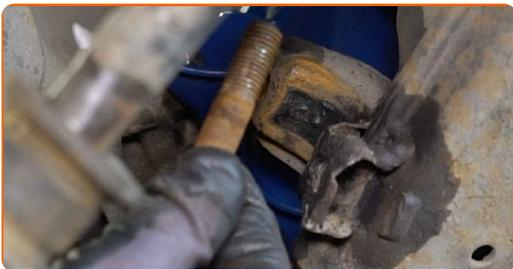
**20** Trennen Sie das Tragelenk vom Achsschenkel. Verwenden Sie einen flachen Metallmeißel. Benutzen Sie einen Hammer. Benutzen Sie ein Brecheisen.
