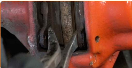
**12** Entfernen Sie die Bremsbeläge.
