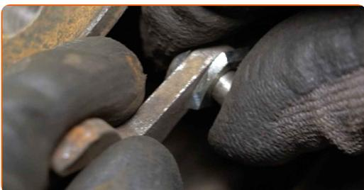
**39** Montieren Sie das Spreizschloss der Feststellbremse.
