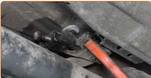
**36** Installieren Sie ein neues Handbremsseil. Benutzen Sie einen Hammer.
