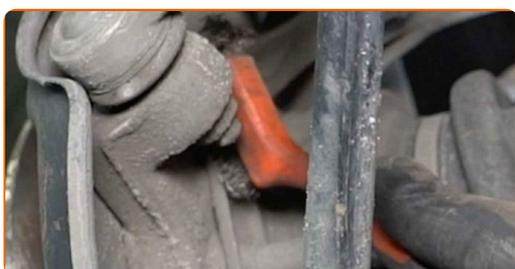
**26** Lösen Sie die Schraube, mit der das Feststellbremsseil am hinteren Achsschenkel befestigt ist. Verwenden Sie Stecknuss Nr. 13. Verwenden Sie einen Ratschenschlüssel.
