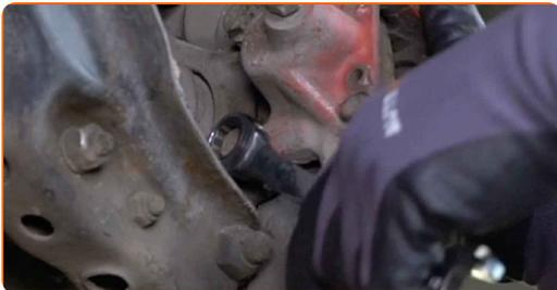
**15** Entfernen Sie die Befestigungsschrauben.
