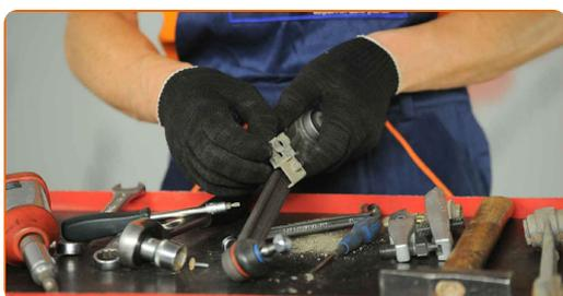
**16** Befestigen Sie die Halterung am Arm. Verwenden Sie den Torx T20. Verwenden Sie einen Ratschenschlüssel.
