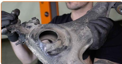
**20** Reinigen Sie die Montagesitze des Achslenkers. Benutzen Sie eine Drahtbürste. Verwenden Sie Allzweckreinigungsspray.
