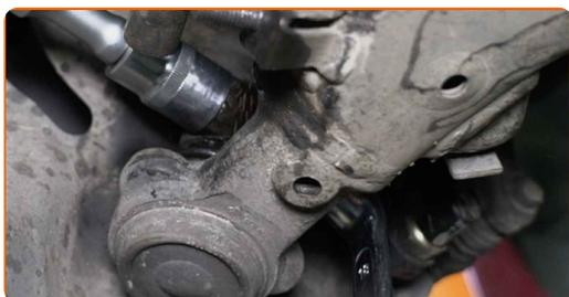
**15** Entfernen Sie die Befestigungsschraube.
