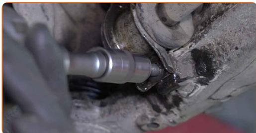
**13** Lösen Sie den Stabilisator vom Querlenker.
