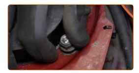
27 Entfernen Sie den Stoßdämpfer.
