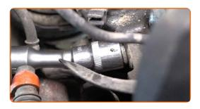
Entfernen Sie die Befestigungsschrauben.
