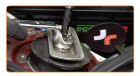
Schrauben Sie die Schraubbefestigungen der oberen Domlager ab. Verwenden Sie Stecknuss Nr. 13. Verwenden Sie einen Ratschenschlüssel.
