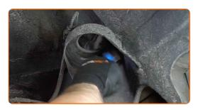
Reinigen Sie die Stoßdämpferaufnahmen. Benutzen Sie eine Drahtbürste. Verwenden Sie Allzweckreinigungsspray.
