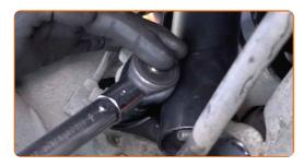
Entfernen Sie die Stütze unter dem Achsschenkel.
