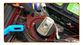
Lösen Sie die Schraubbefestigungen der oberen Domlager. Verwenden Sie Stecknuss Nr. 13. Verwenden Sie einen Ratschenschlüssel.
