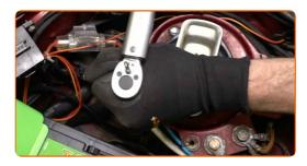
Entfernen Sie die Kotflügel-Abdeckung.
