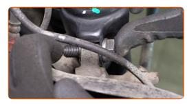
Ziehen Sie die unteren Befestigungen am Stoßdämpfer an. Verwenden Sie Stecknuss Nr. 19. Verwenden Sie einen Drehmomentschlüssel. Ziehen Sie ihn mit 110 Nm Drehmoment fest.
