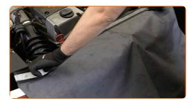
Reinigen Sie die Befestigungselemente des Stoßdämpferdomlagers. Benutzen Sie eine Drahtbürste. Benutzen Sie WD-40-Spray.
