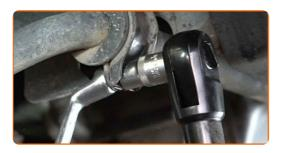
Entfernen Sie die Befestigungsschrauben.
