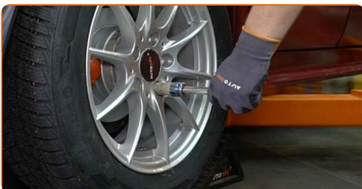
**30** Entfernen Sie den Wagenheber sowie die Unterlegkeile.
