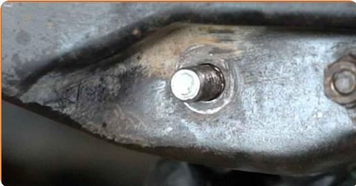
**22** Zum korrekten Anziehen der Befestigungen müssen Sie die Komponenten der Aufhängung in ihre Arbeitsposition heben.
