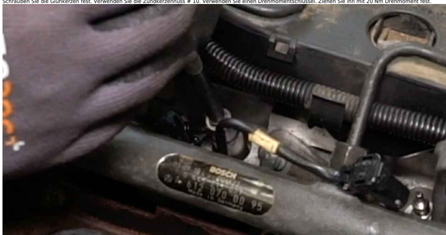
16 Schrauben Sie die Glühkerzen fest. Verwenden Sie die Zündkerzennuss # 10. Verwenden Sie einen Drehmomentschlüssel. Ziehen Sie ihn mit 20 Nm Drehmoment fest.
