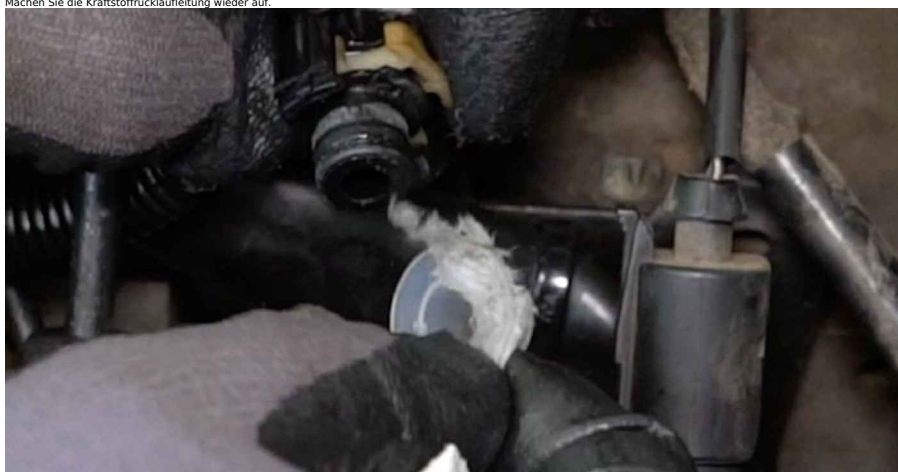
21 Schließen Sie den Schlauch der Kraftstoffrücklaufleitung an.
