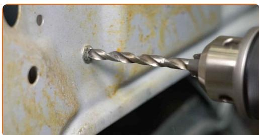
**27** Entfernen Sie den Fensterhebermechanismus.
