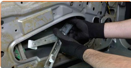
**34** Sprühen Sie den Mechanismus des Fensterhebers ein. Verwenden Sie ein Mehrzweck-Lithiumfett.
