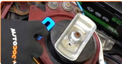
**4** Reinigen Sie die Befestigungen vom Stoßdämpferschaft. Benutzen Sie eine Drahtbürste. Benutzen Sie WD-40-Spray.
