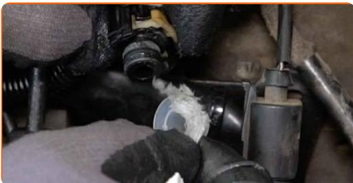
**21** Schließen Sie den Schlauch der Kraftstoffrücklaufleitung an.
