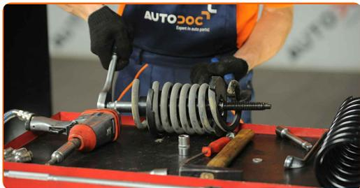
**14** Dekomprimieren Sie die Feder.
