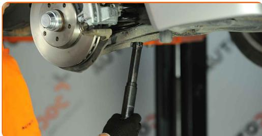
**25** Ziehen Sie den unteren Befestiger des Stoßdämpfers an. Verwenden Sie Ring-Gabelschlüssel Nr. 17. Verwenden Sie Stecknuss Nr. 17. Verwenden Sie einen Drehmomentschlüssel. Ziehen Sie ihn mit 55 Nm Drehmoment fest.
