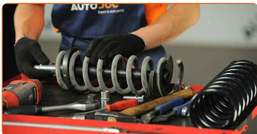
**16** Reinigen Sie die Aufnahmen der Spiralfedern.
