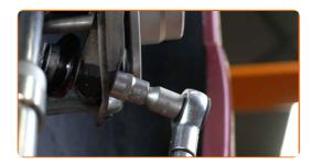
Entfernen Sie die Abstützung unter dem hinteren Achsschenkel.
