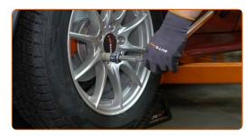
Entfernen Sie den Wagenheber sowie die Unterlegkeile.
