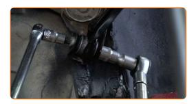
Ziehen Sie das Befestigungselement an, das den Aufhängungsarm mit dem hinteren Achsschenkel verbindet. Verwenden Sie Ring-Gabelschlüssel Nr. 18. Benutzen Sie den XZN #12. Verwenden Sie einen Drehmomentschlüssel. Ziehen Sie ihn mit 70 Nm Drehmoment fest.
