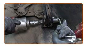
Schrauben Sie das Befestigungselement ab, das den Achslenker mit dem Achsschenkel verbindet. Verwenden Sie Ring-Gabelschlüssel Nr. 18. Benutzen Sie den XZN #12. Verwenden Sie einen Ratschenschlüssel.
