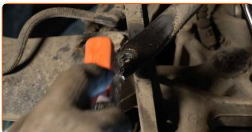
**12** Montieren Sie den Querlenker.
