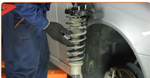
**30** Schrauben Sie die obere Befestigung des Domlagers an.
