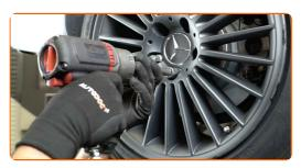
Senken Sie das Auto und ziehen Sie die Radschrauben über Kreuz an. Verwenden Sie eine Schlagnuss für Felgen # 17. Verwenden Sie einen Drehmomentschlüssel. Ziehen Sie ihn mit 130 Nm Drehmoment fest.
