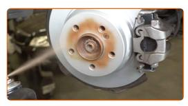
Die Bremsscheibenoberfläche reinigen. Benutzen Sie einen Bremsenreiniger.
