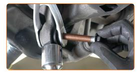
Schrauben Sie die Befestigungen ein, die den Querlenker mit dem Hinterachsgelenk verbinden. Verwenden Sie Ring-Gabelschlüssel Nr. 18. Verwenden Sie Stecknuss Nr. 18. Benutzen Sie den XZN #12. Verwenden Sie einen Ratschenschlüssel.
