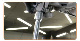
Entfernen Sie die Befestigungsschrauben. Benutzen Sie den XZN #12. Verwenden Sie einen Ratschenschlüssel.
