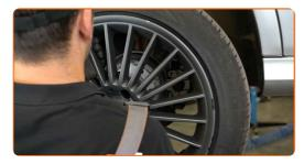
Schrauben Sie die Befestigungen der Kunststoffschutzabdeckung der Karosserie ab. Verwenden Sie Stecknuss Nr. 10. Verwenden Sie einen Ratschenschlüssel.
