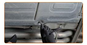
Entfernen Sie die Kunststoffschutzabdeckung der Karosserie.
