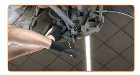
Schrauben Sie die Befestigung ab, die den Querlenker mit dem Hilfsrahmen verbindet. Verwenden Sie Ring-Gabelschlüssel Nr. 18. Verwenden Sie Stecknuss Nr. 18. Benutzen Sie den XZN #12. Verwenden Sie einen Ratschenschlüssel.
