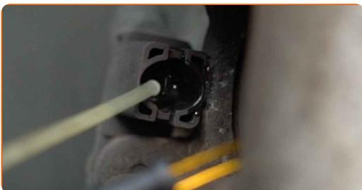
**23** Bringen Sie den Steckverbinder des Verschleißsensors der Bremsbeläge an.
