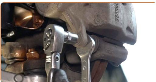
**11** Entfernen Sie die Befestigungsschrauben.
