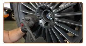
Stellen Sie die Radlager ein. Verwenden Sie Ring-Gabelschlüssel Nr. 32.
