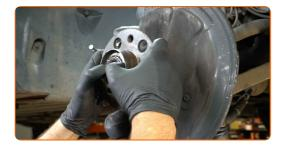
Reinigen Sie den Befestigungssitz der Radnabe. Verwenden Sie Allzweckreinigungsspray.
