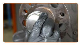
Reinigen Sie die Nabe. Benutzen Sie eine Drahtbürste. Behandeln Sie die Kontaktfläche. Benutzen Sie ein Kupferschmiermittel.
