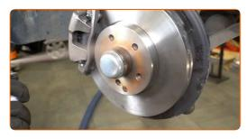
Die Bremsscheibenoberfläche reinigen. Benutzen Sie einen Bremsenreiniger.
