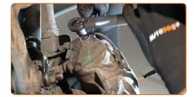
Bringen Sie den Steckverbinder des Verschleißsensors der Bremsbeläge an.
