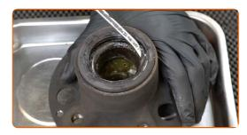
Entfernen Sie das Radnabenlager.
