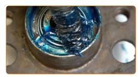
Die neue Radnabe mit einem Lager montieren.
