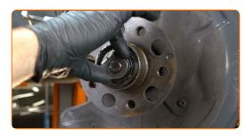
Entfernen Sie die Befestigungsmutter.
