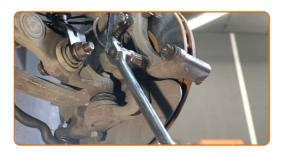
20 Entfernen Sie die Sattelhalterung.
