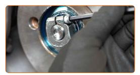
Behandeln Sie das Radnabenlager. Verwenden Sie Mehrzweckfett.
