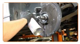
Entfernen Sie das Radnabenlager.
