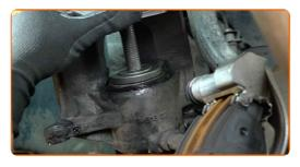
16 Entfernen Sie die Bremsbeläge.
