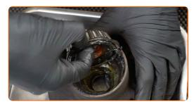
Reinigen Sie den Einbauort für die Nabenlagerung.
