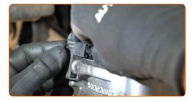
Entfernen Sie die Radnabenkappe.
