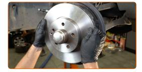
Ziehen Sie die Befestigung der Bremsscheibe fest. Verwenden Sie den Torx T30. Verwenden Sie einen Drehmomentschlüssel. Ziehen Sie ihn mit 8 Nm Drehmoment fest.
