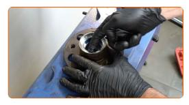
Setzen Sie den Innenring des Radlagers in die Nabe ein. Verwenden Sie einen Druckstücksatz mit Ein-/Auspresswerkzeug.
