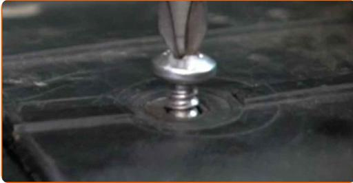
**25** Schrauben Sie die Befestigungsschrauben des Einlassrohrs ein. Verwenden Sie einen Kreuzschlitzschraubendreher. Verwenden Sie Stecknuss Nr. 10. Verwenden Sie einen Ratschenschlüssel.
