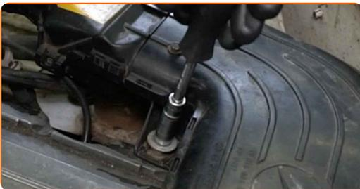
**5** Entfernen Sie die Befestigungsschrauben.
