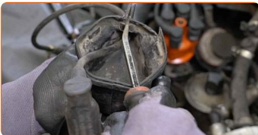
**18** Setzen Sie das neue Hochspannungskabel in die Zündspulenabdeckung ein.
