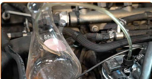
**24** Reinigen Sie den Kraftstofffilter. Verwenden Sie Allzweckreinigungsspray.
