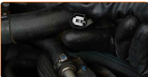
**6** Lösen Sie das Unterdruckventil aus seinem Montagesitz und legen Sie es beiseite. Benutzen Sie ein Brecheisen.
