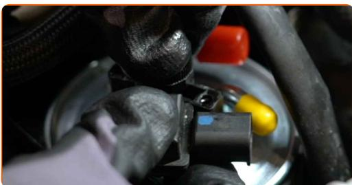
**17** Schrauben Sie die Befestigungselemente des WIF-Sensors ein. Verwenden Sie den Torx T20.
