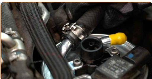
**19** Ziehen Sie die Befestigungsklemme der Kraftstofffilterleitung an. Verwenden Sie eine Clic-R-Kragenzange.
