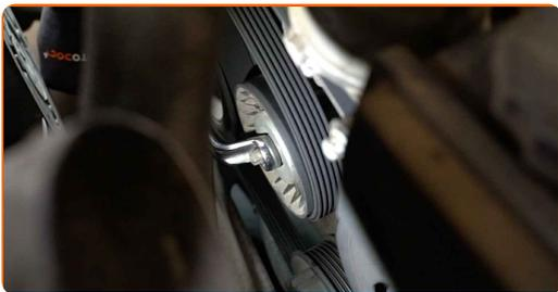
**6** Entfernen Sie den Keilrippenriemen.
