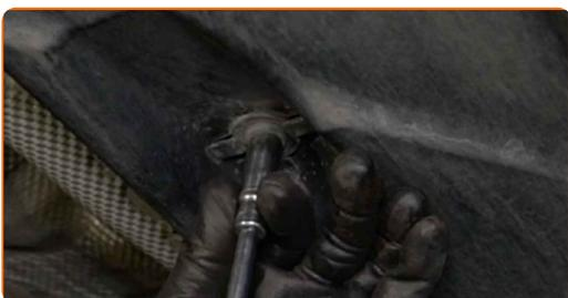
**35** Montieren Sie die Kunststoffabdeckung des Achslenkers.
