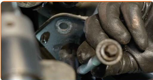
**16** Schrauben Sie die Befestigung ab, die den Querlenker mit dem Hilfsrahmen verbindet. Verwenden Sie Ring-Gabelschlüssel Nr. 18. Benutzen Sie den XZN #12. Verwenden Sie einen Ratschenschlüssel.
