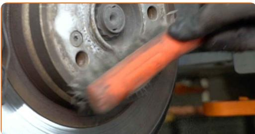
**37** Behandeln Sie die Oberfläche, an der die Bremsscheibe die Felge berührt. Verwenden Sie Keramikfett.
