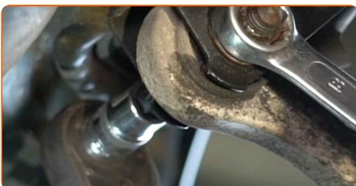
**17** Entfernen Sie die Befestigungsschraube.
