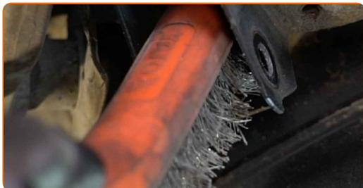
**20** Reinigen Sie die Montagesitze der Hilfsrahmenhalterung. Benutzen Sie eine Drahtbürste. Benutzen Sie WD-40-Spray.
