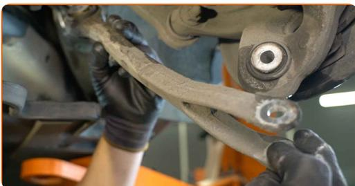
**19** Reinigen Sie die Montagesitze des Querlenkers. Benutzen Sie eine Drahtbürste. Benutzen Sie WD-40-Spray.
