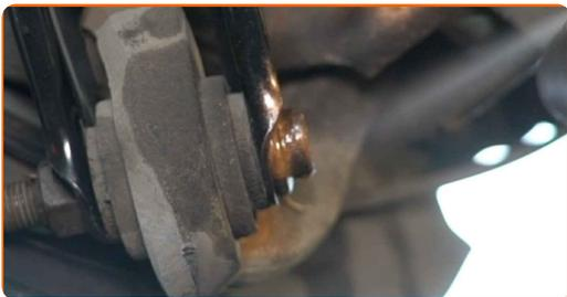
**34** Schrauben Sie die Befestigungselemente der Kunststoffabdeckung des Unterbodens ein. Verwenden Sie Stecknuss Nr. 10. Verwenden Sie einen Ratschenschlüssel.
