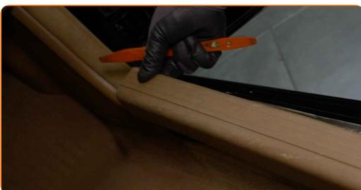
**3** Entfernen Sie den Dichtungsstreifen der Türöffnung.
