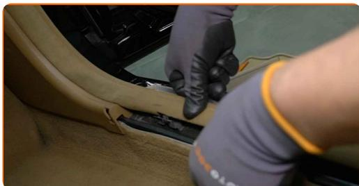
**15** Montieren Sie die innere Verkleidung des Türschwellers.
