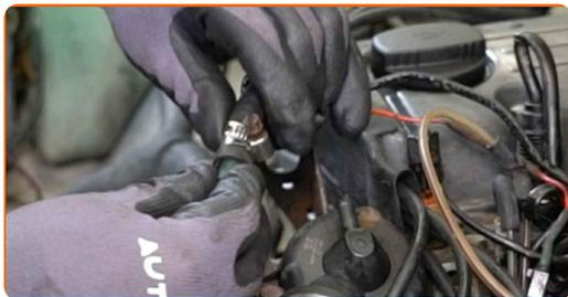
**11** Lösen Sie den Kühlmittelschlauch.
