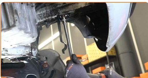
**23** Montieren Sie den Stabilisator.
