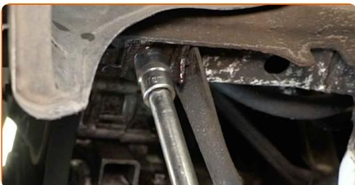
**13** Entfernen Sie die Befestigungsschrauben.
