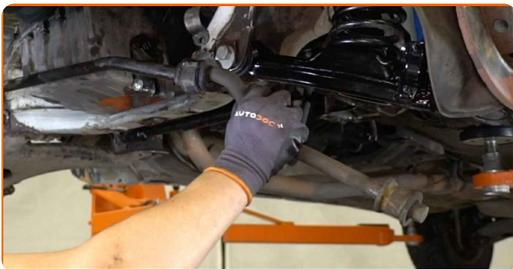
**11** Reinigen Sie die Befestigungsschrauben der Halter der Stabilisatorlagerung. Benutzen Sie eine Drahtbürste. Benutzen Sie WD-40-Spray.
