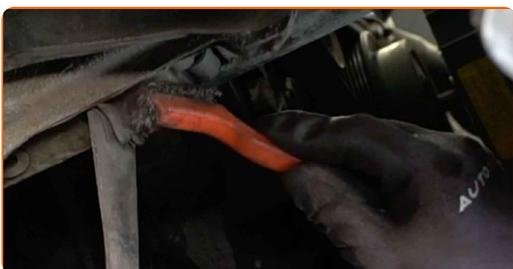
**12** Lösen Sie die Befestigungsschrauben der Halter der Stabilisatorlagerung. Verwenden Sie Stecknuss Nr. 17. Verwenden Sie einen Ratschenschlüssel.
