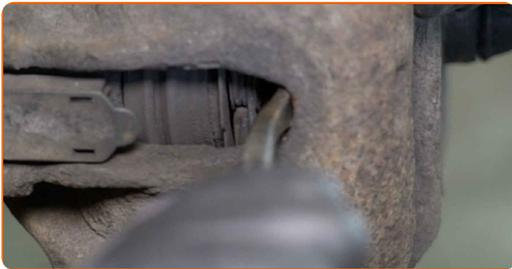
**13** Entfernen Sie die Befestigungsschrauben.
