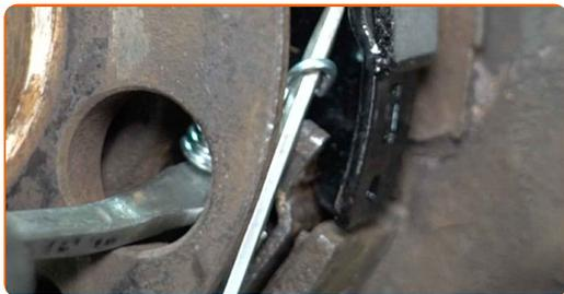
**47** Stellen Sie die Spannung des Feststellbremssseils ein. Verwenden Sie Stecknuss Nr. 13. Verwenden Sie einen Ratschenschlüssel.
