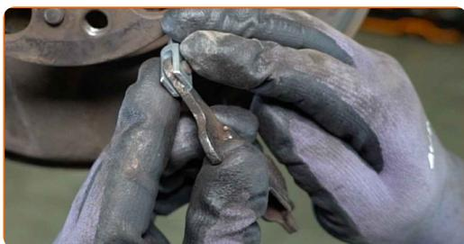
**40** Montieren Sie das Spreizschloss der Feststellbremse.
