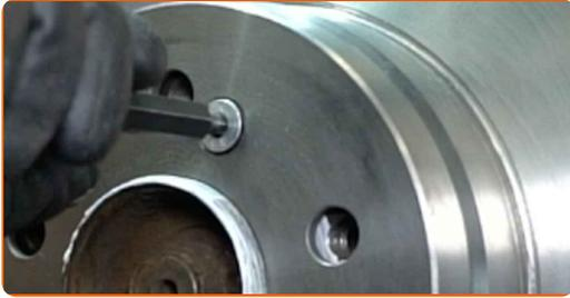
**52** Schrauben Sie die Befestigungen der Bremsscheibe fest. Verwenden Sie Inbusschlüssel Nr. H5. Verwenden Sie einen Drehmomentschlüssel. Ziehen Sie ihn mit 10 Nm Drehmoment fest.
