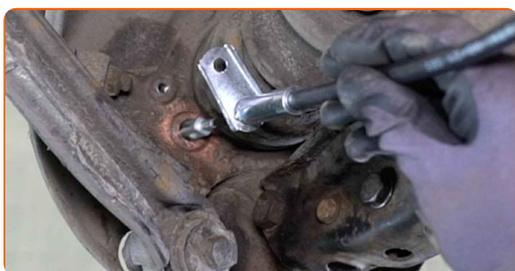
**38** Ziehen Sie die Schraube fest, mit der das Feststellbremsseil am hinteren Achsschenkel befestigt ist. Verwenden Sie Stecknuss Nr. 13. Verwenden Sie einen Drehmomentschlüssel. Ziehen Sie ihn mit 24 Nm Drehmoment fest.
