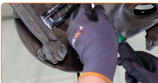
**39** Bringen Sie den Stift an, der das Bremsseil mit dem Spreizschloss der Feststellbremse verbindet.
