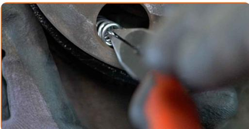
**46** Bauen Sie die untere Rückstellfeder ein. Verwenden Sie einen flachen Schraubendreher.
