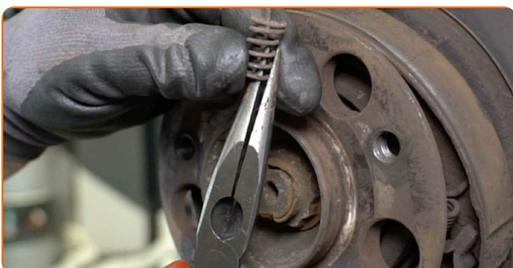
**23** Entfernen Sie den Nachsteller der Feststellbremse.
