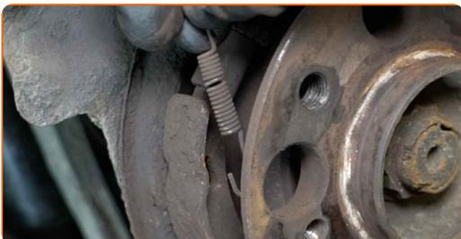
**22** Entfernen Sie die Niederhaltefedern der Feststellbremsbacken. Verwenden Sie eine Spitzzange.
