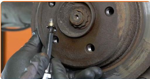
**20** Entfernen Sie die Bremsscheibe.
