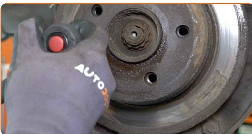
**19** Entfernen Sie die Befestigungsschraube.
