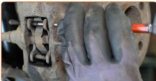
**10** Entfernen Sie die Rückholfeder der Bremsbeläge.
