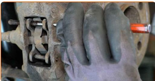
**10** Entfernen Sie die Rückholfeder der Bremsbeläge.
