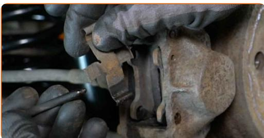
**11** Verteilen Sie die Bremsbeläge. Benutzen Sie ein Brecheisen (2 Teile).
