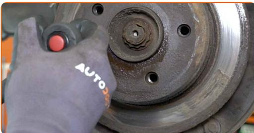
**19** Entfernen Sie die Befestigungsschraube.
