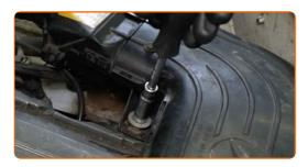
5 Entfernen Sie die Befestigungsschrauben.
