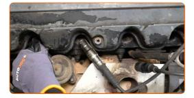
Entfernen Sie Schmutz, Staub und Ablagerungen von den Zündkerzenbohrung.
