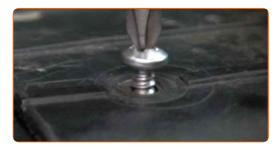
Schrauben Sie die Befestigungsschrauben des Einlassrohrs ein. Verwenden Sie einen Kreuzschlitzschraubendreher. Verwenden Sie Stecknuss Nr. 10. Verwenden Sie einen Ratschenschlüssel.
