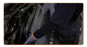
Trennen Sie die Erdungskabelklemme von der Batterie. Verwenden Sie Ring-Gabelschlüssel Nr. 10.
