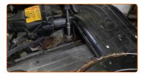
Schließen Sie die Erdungskabelklemme an der Batterie an.
